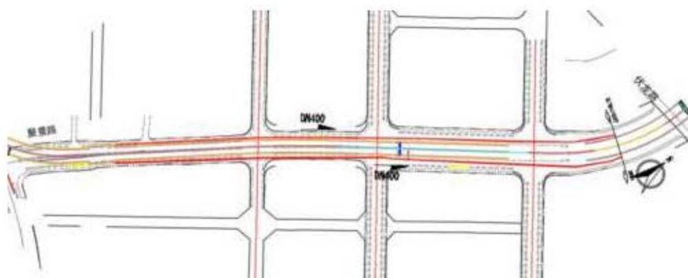
图 2-17 汇墅路聚景路污水管道系统图
