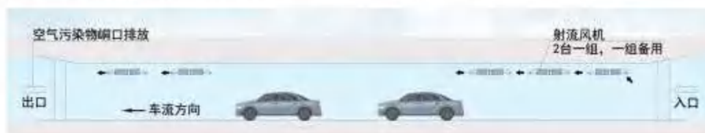
图 2-14 隧道纵向通风、排烟示意图
